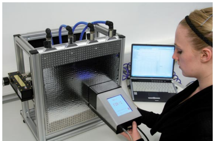
Bestimmung des Wärmeemissionsgrades von Folien mit dem Gerät INGLAS TIR 100-2. Die Folie wird gehalten von einer Probenhalterung mit thermischer Ankopplung (Eigenbau)
