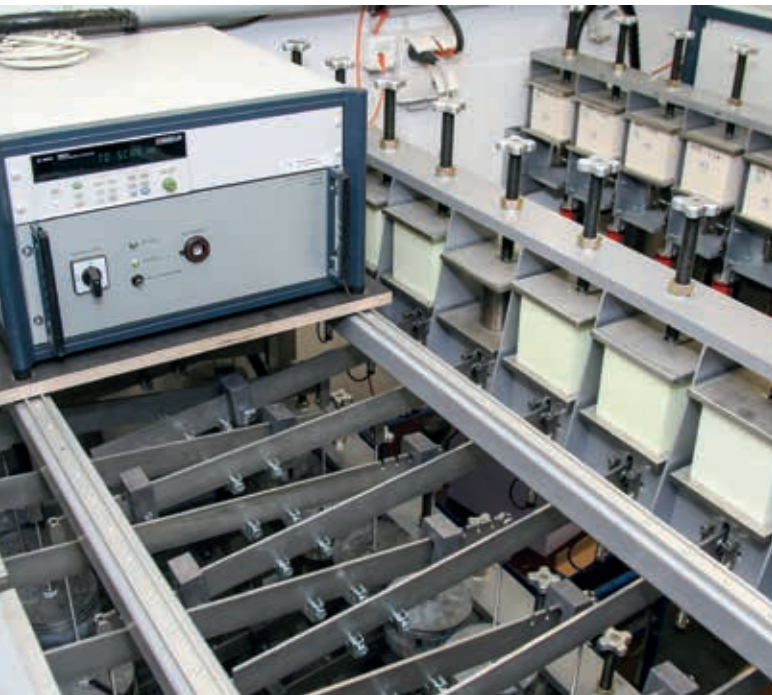
† Versuchseinrichtung zum Langzeit-Kriechverhalten
