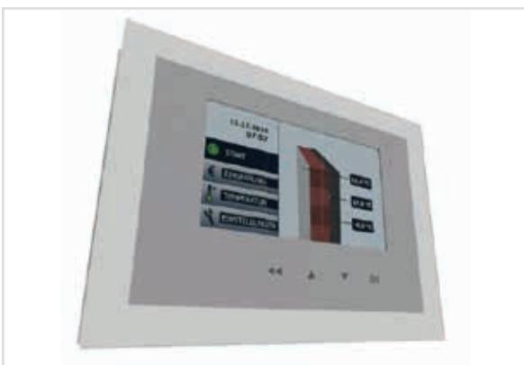
† Das Vorserienmodell des WDVS-Tacho: Der Mikrocomputer mit grafischer Bedienoberfläche wird mit einer sensorbestückten Dämmplatte der Außendämmung verbunden und enthält selbst Sensoren zur Bestimmung der Oberflächentemperatur der Außenwand.
