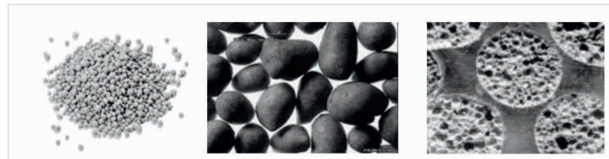
† Blähglas: Links: loses Granulat, Mitte: einzelne Partikel mit einem Durchmesser von ca. 1 mm bis 2 mm, Rechts: Querschnitt durch Partikel, die innere poröse Struktur ist sichtbar.
