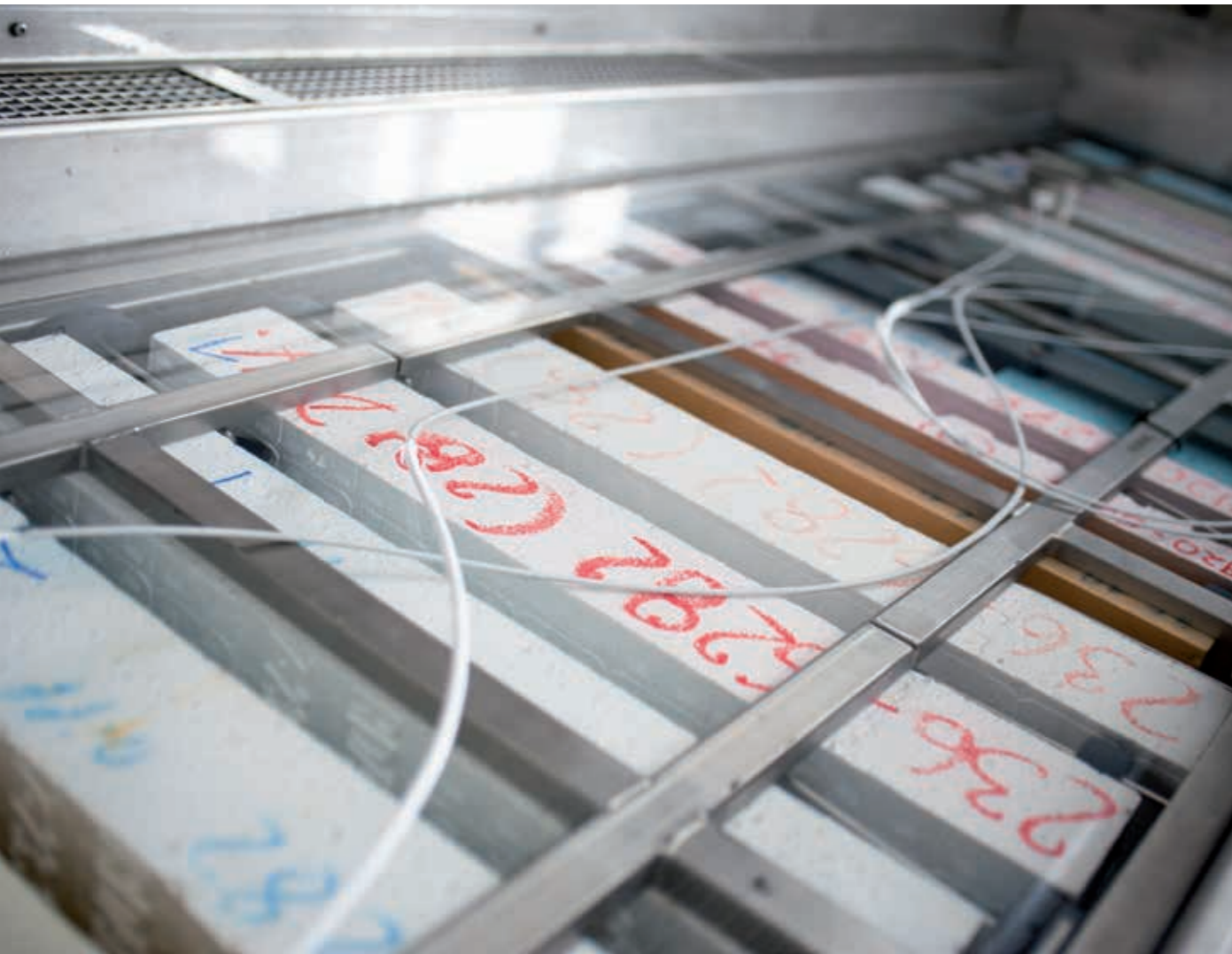
† Prüfeinrichtung zur Bestimmung des Verhaltens bei Frost-Tau-Wechselbeanspruchung
