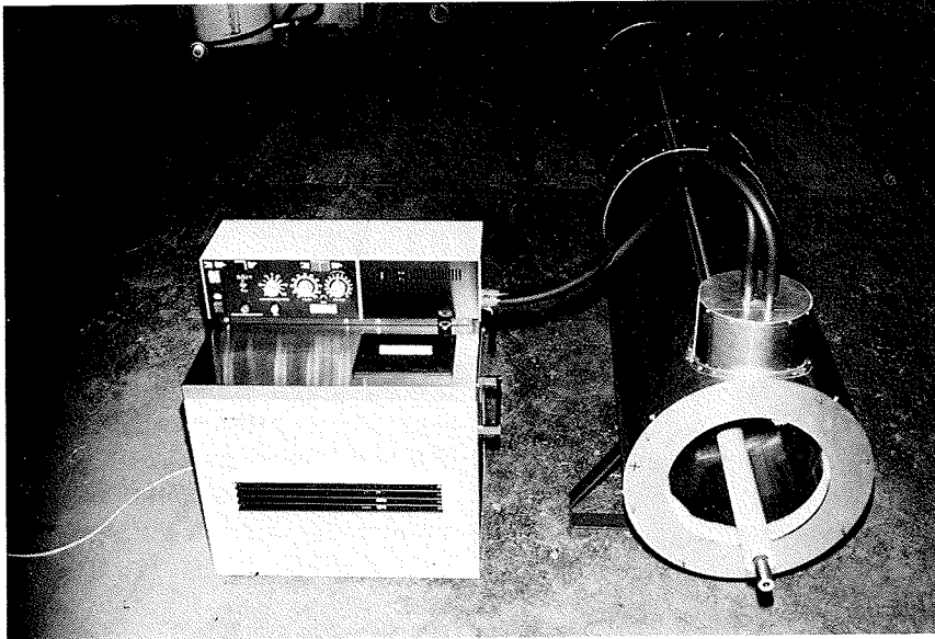
Bild 1: Ansicht der Prüfeinrichtung mit zylindrischem Prüfraum und Kryostat sowie dem Prüfrohr \varnothing 27 mm mit aufgebrachtem Isolierschlauch.
